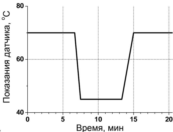
показания датчика составляли  $70\text{ }^{\circ}\text{C}$  (+1). Так как вода практически несжимаема, то скорость движения воды изменяется по всей трубе практически одновременно.
