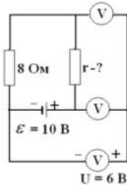
8. В схему включены три одинаковых вольтметра с большим внутренним сопротивлением, идеальная батарея с ЭДС  $\varepsilon = 10$  В и резисторы, один с сопротивлением  $r_1 = 8$  Ом и другой с неизвестным сопротивлением  $r$ . Найдите  $r$ , если нижний вольтметр показывает напряжение  $U = 6$  В. Его полярность указана на схеме.
