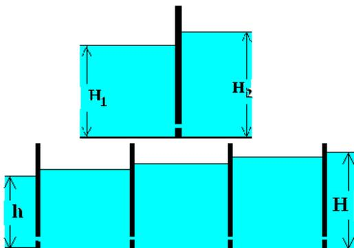
**8.** Канал между двумя озёрами перекрыт четырьмя щитами с отверстием внизу. В установившемся режиме уровни воды в озёрах  $h$  и  $H$  и в отсеках между щитами остаются постоянными. Объём ежесекундно проходящей через отверстие щита воды  $q = \alpha\sqrt{H_2 - H_1}$ , где  $H_2$  и  $H_1$  уровни воды справа и слева от щита, а коэффициент  $\alpha$
